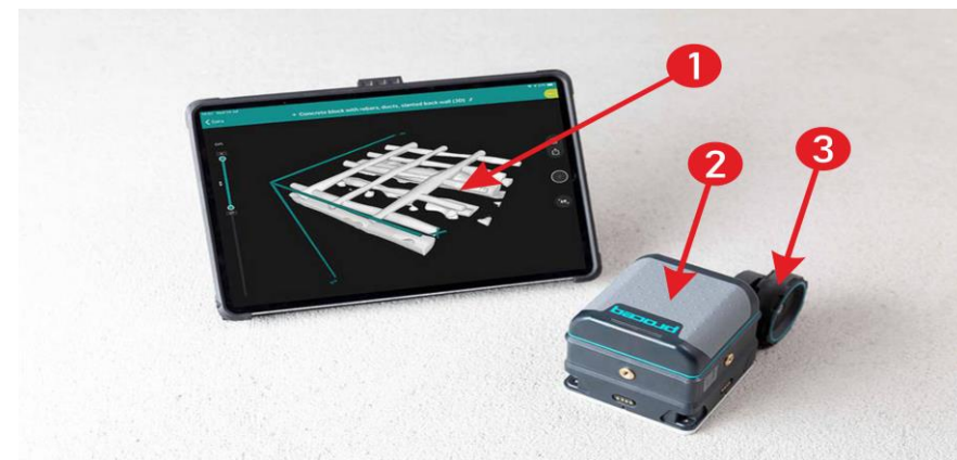
Георадары Proceq GP 8000, GP 8800 с частотным диапазоном 0,2...4,0 ГГц Глубина до 70см
