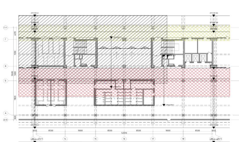
Положение георадиолокационного профиля и его пикет
